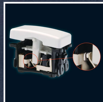
Contactos de plata que garantizan más de 40,000 maniobras en su mecanismo.
